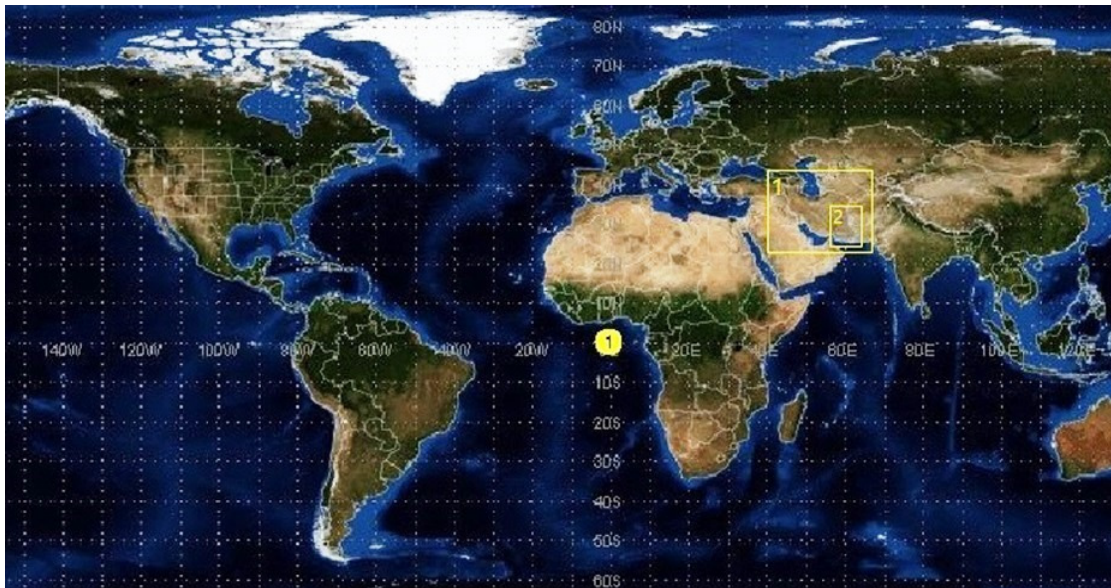
شکل ۲. تفکیک افقی ۳۰ کیلومتر برای آشیانه اول و ۱۰ کیلومتر برای آشیانه دوم
